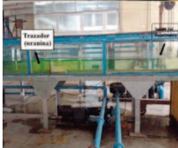
Figura 7. Canal de fluido donde se vierte el trazador a un extremo. Se observa el movimiento del trazador dentro del canal de fluido y la sonda de medición del fluorímetro sumergida en el agua.
