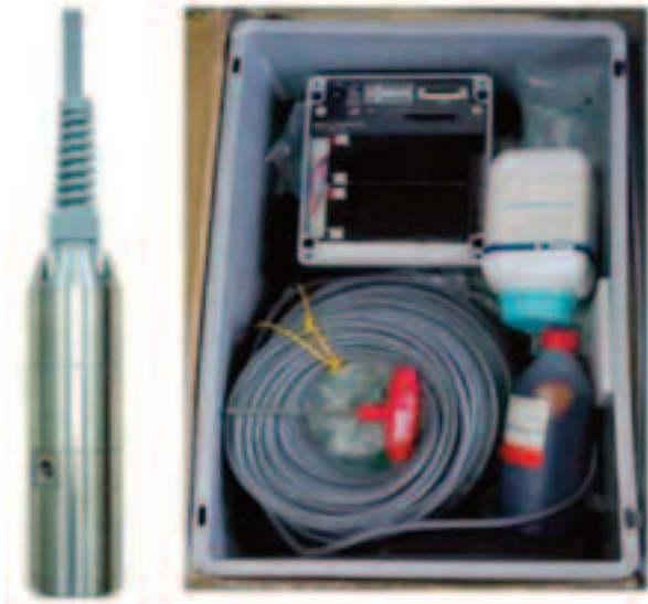
Figura 1. Fluorímetro GGUN-FL 24: sonda de medición, caja registradora, cables de conexión y frascos con los dos trazadores (uranina y aminoácido G).
