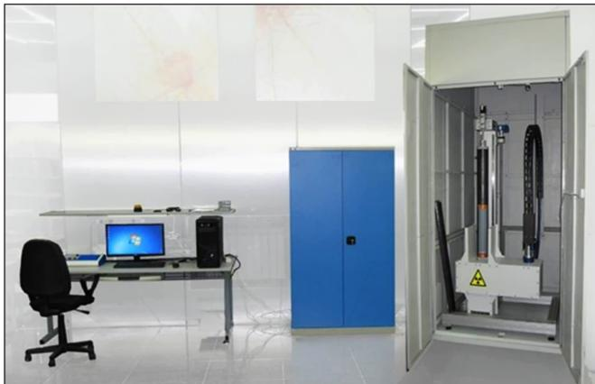
**Figura 2.** Escáner de tomografía computarizada PKT-180-1 con compuertas abiertas del bloque protector (Instituto de Investigaciones Científicas de Petróleo y Gas de toda Rusia - VNIIneft, 2017).
