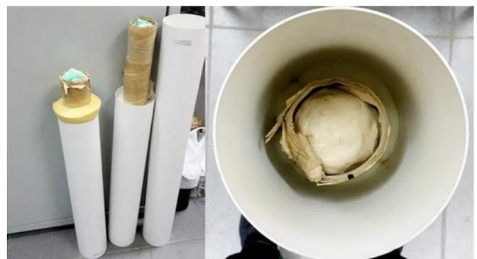
**Figura 4.** Colocación de muestras en tubo plástico de 125 mm en diámetro (VNIIneft, 2017).
