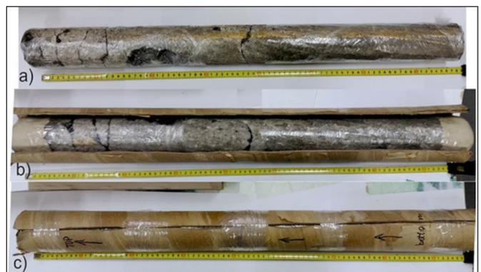
**Figura 3.** Preparación secuencial de muestras para el macro escaneo computarizado. a) Aplicación de amplificadores de las muestras; b) Colocación en caja rígida de cartón e instalación de tapas de extremos para eliminar artefactos marginales; c) Sujeción de muestras (VNIIneft, 2017).
