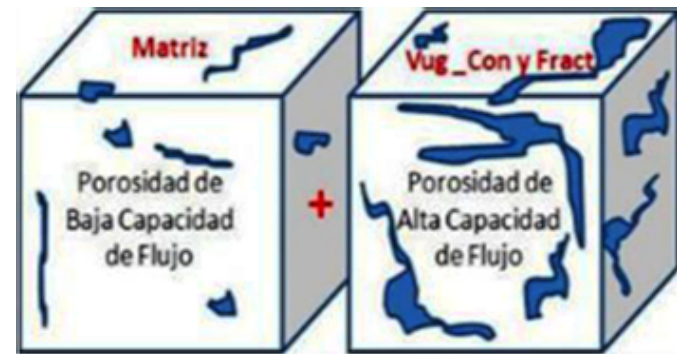
Figura 1. Modelo del medio poroso. La matriz presenta bajas permeabilidades, mientras que los vugulos y fracturas aportan la mayor permeabilidad al sistema.
