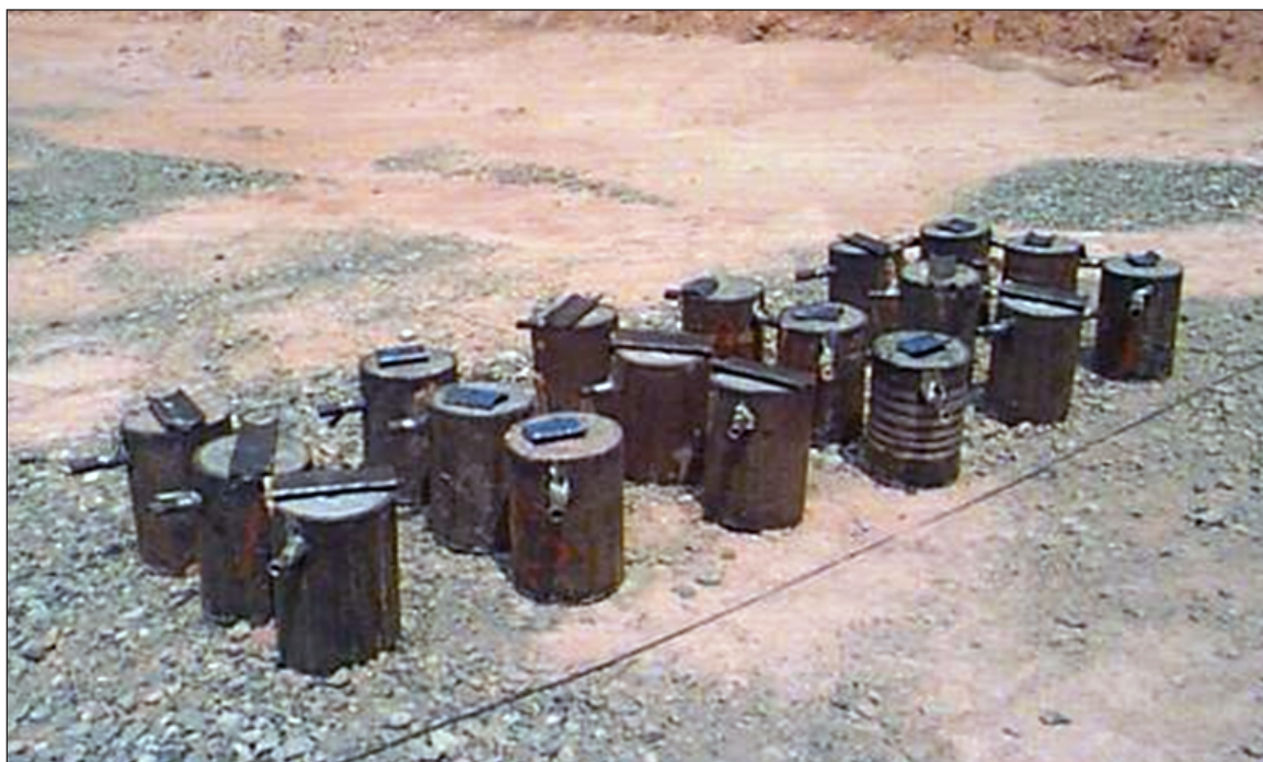
Figura 10. Disposición de muestras experimentales en contenedores.
