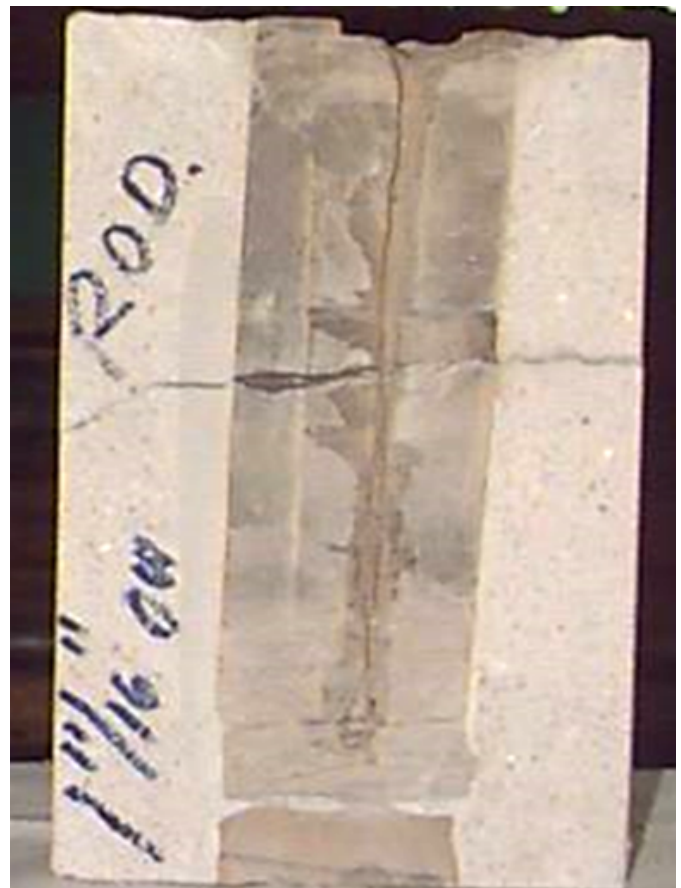
Figura 19. Núcleo del pozo 2 que muestra la penetración del disparo de prueba.
