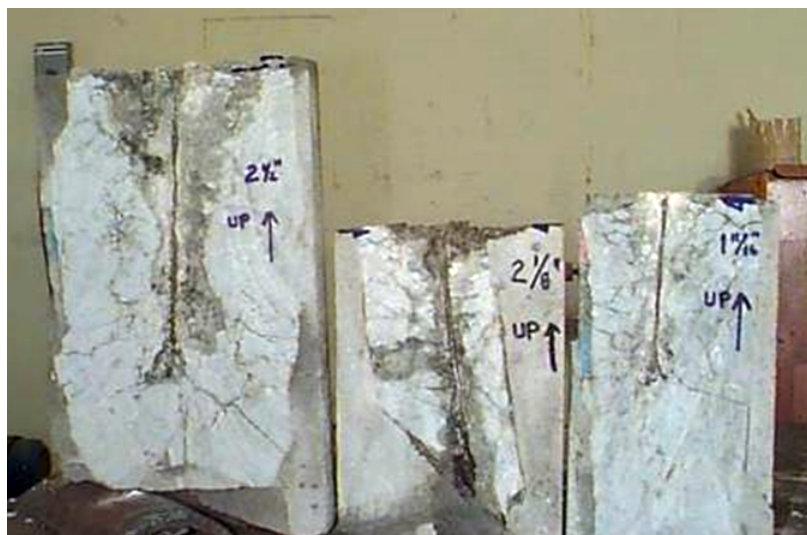
Figura 16. Penetración de disparos en blancos de granito.
