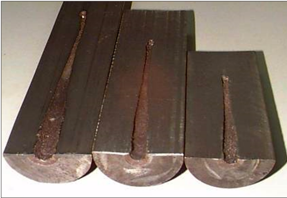
Figura 17. Penetración de disparos en blancos de acero: diámetro 2 1/2", fase 60°, penetración 6.625"; diámetro 2 1/8", fase 40°, penetración 4.968"; diámetro 1 1/8", fase 40°, penetración 3.375".
