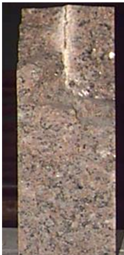
Figura 15. Blanco de granito con una perforación producida por una pistola de 1 1/8" de diámetro.
