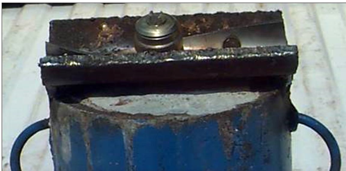
Figura 11. Blanco de roca caliza con carga de 1 1/4" del proveedor B y lámina de T.R. de 5", 18 lb/pie.
