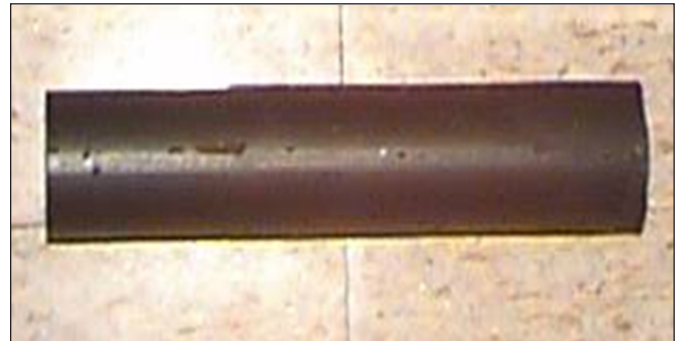
Figura 9. Muestra experimental del blanco de acero ASTM A36-94.
