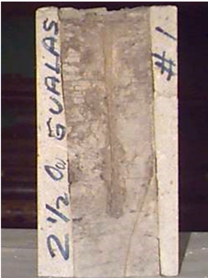
Figura 18. Núcleo del pozo 1 que muestra la penetración del disparo de prueba.
