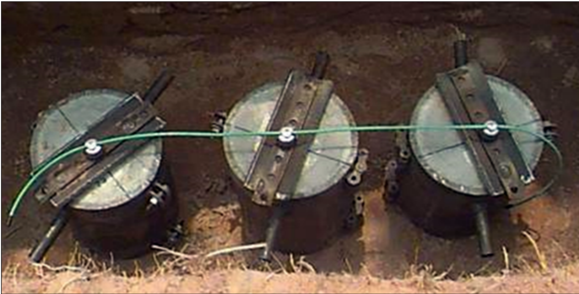
Figura 12. Cargas de 1 1/8", del proveedor A y lámina de T.R. de 5", 18 lb/pie.
