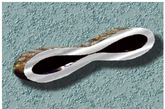
Figura 2. Tubería de 7" de diámetro, colapsada
