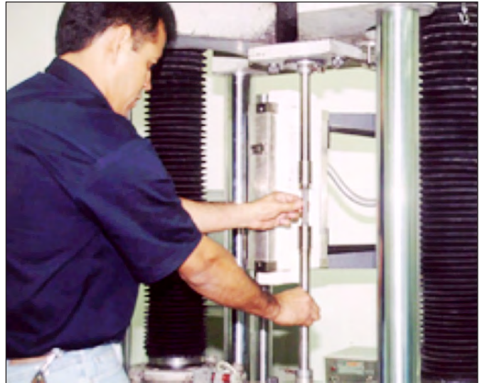
Figura 11. Colocación de la probeta en la máquina de tensión
