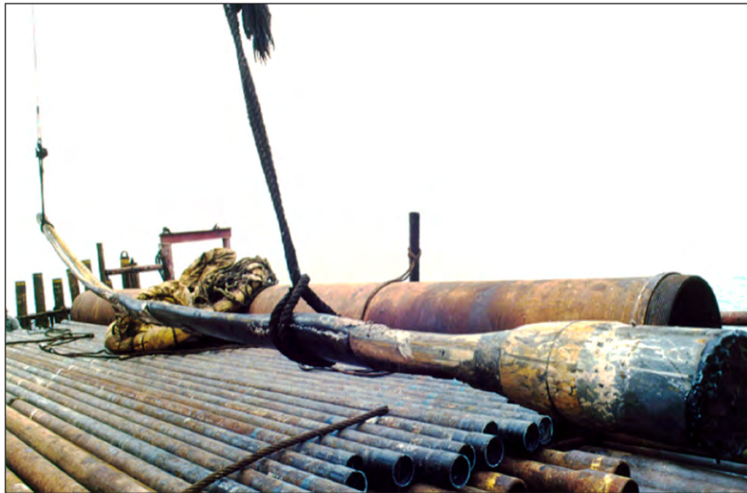
Figura 4, Tubería de 7" de diámetro, fabricada con acero tipo P-110, 26 Lb/pie, colapsada
