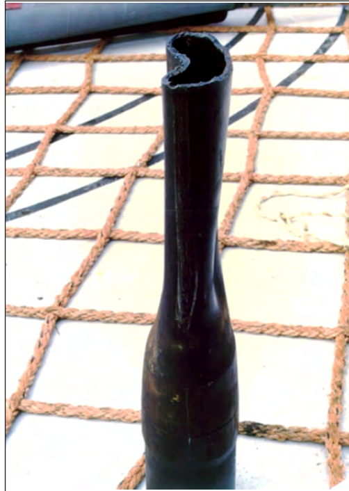
Figura 3, Tubería de 7" de diámetro fabricada con acero P-110, 26 Lb/pie, colapsada.
