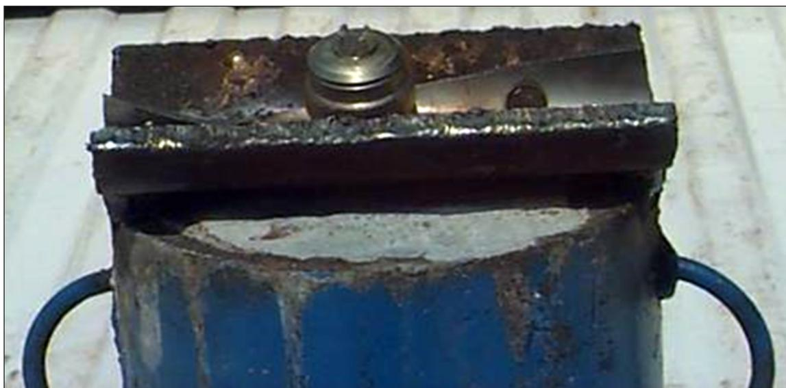
**Figura 11.** Blanco de roca caliza con carga de 1 "1/8" del proveedor B y lámina de T.R. de 5", 18 lb/pie.
