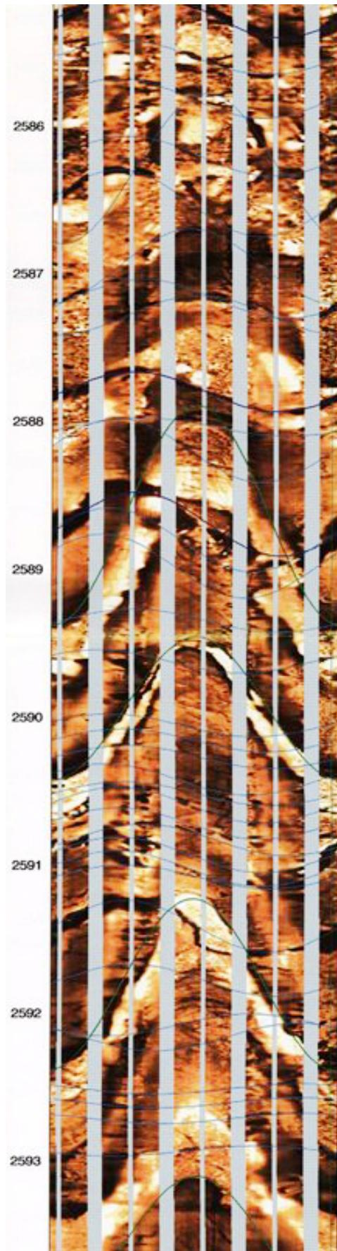
**Figura 11.** Intervalo del registro de imagen FMI del pozo X-C1. Se puede apreciar el alto fracturamiento predominante en el reservorio. La curva verde representa los límites de capa, las azules las fracturas abiertas y la violeta las trazas vulgares.
