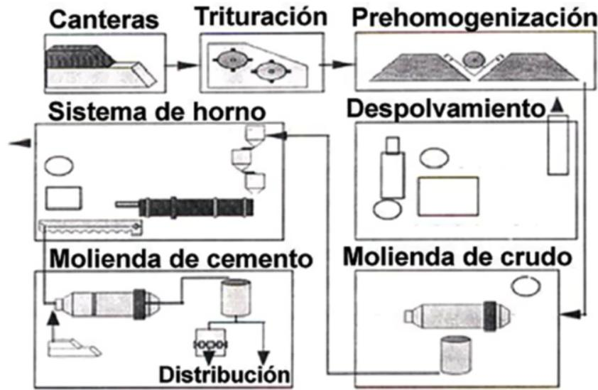
Figura 1. Esquema general del proceso de fabricación del cemento
