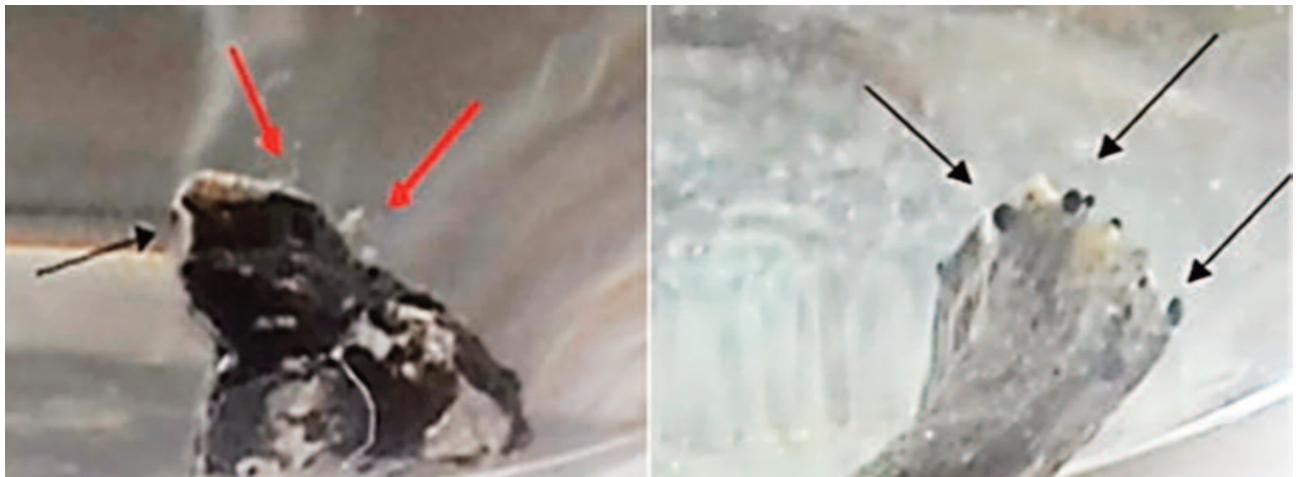
Figura 1. Incubación en medio de cultivo mínimo de las cepas bacterianas con las muestras de roca. Se señala con flechas negras las gotas de petróleo desplazadas desde la matriz y con rojas el material mucoide adherido a la superficie.
