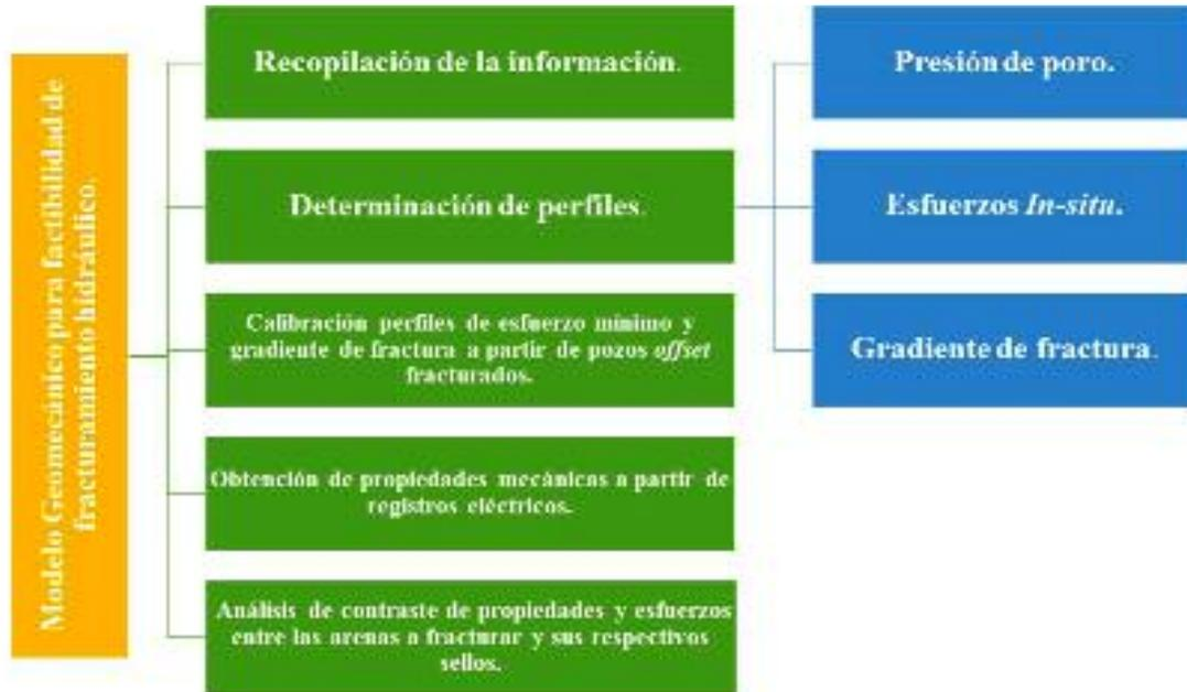
**Figura 2.** Metodología general para modelado geomecánico aplicado al fracturamiento hidráulico
