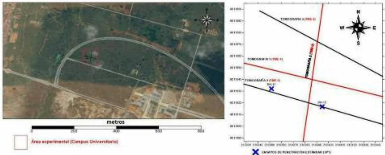
Figura 2. Disposición de las líneas de Tomografía Eléctrica en el área experimental.
