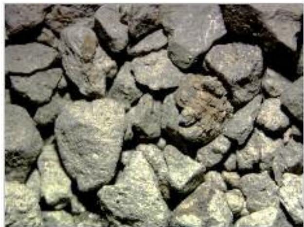
Figura 2. Claystone silíceo-arcillosos radiolárico 10x.
