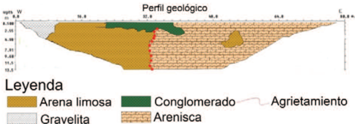
Figura 13. Modelo geológico del talud del Castillo de Santo Domingo de Atarés (Elaboración de los autores).
