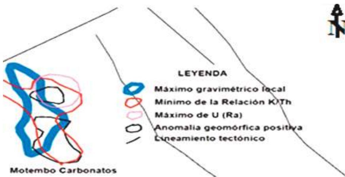
Figura 15. Complejo Anómalo Motembo Carbonatos, al centro este del Bloque 9: en azul, máximo gravimétrico local; en rojo, anomalía de la Relación K/eTh ; en rosado, máximo de U (Ra) ; en negro, máximo residual del relieve y dislocaciones tectónicas (Pardo Echarte et al. , 2016)
