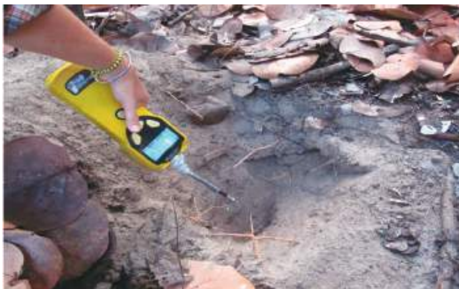
Figura 9. Muestreo en estación G-4, donde se observa el Fotoionizador utilizado en la medición de los gases de campo.
